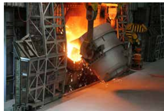
2017 年 6 月 1 日鐵水注入轉爐吹煉
